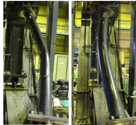
CBB(偏心0mm) BIE(偏心60mm) 曲げ変形形状(圧縮時層間変形角1.5%)
